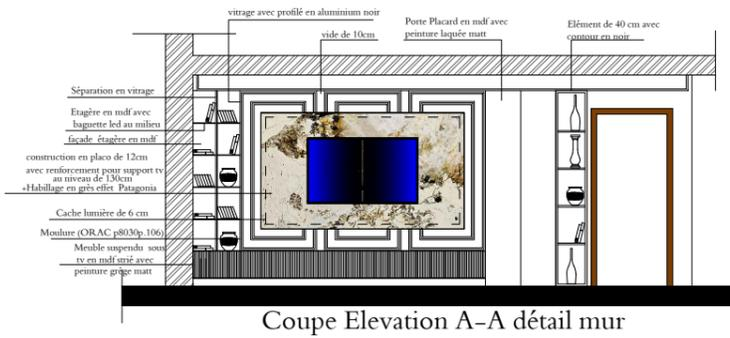
Coupe Elevation A-A détail mur
